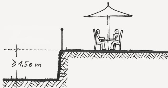
Figure 5 : garde-corps dans les aménagements extérieurs
